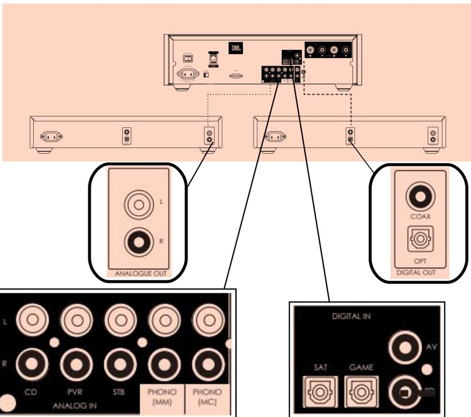
3. Seu SA750 permite a conexão de caixas de som de várias formas diferentes. Segue abaixo o exemplo de uma ligação básica.
